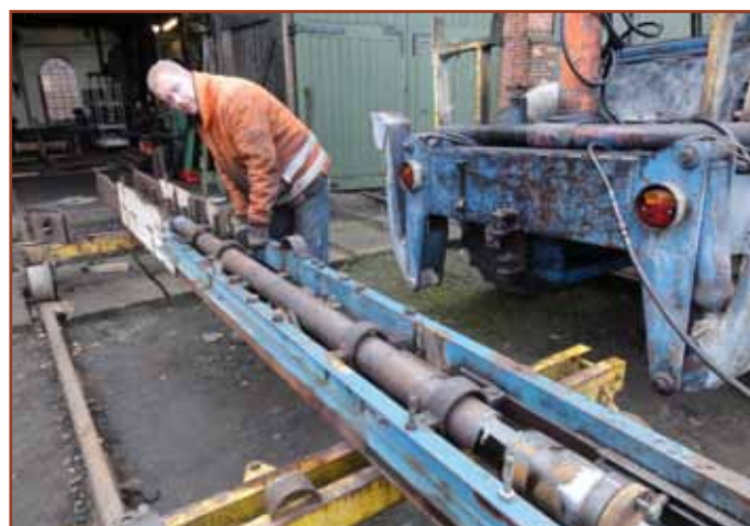
Der arbejdes med overhederrør
